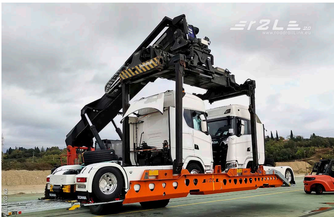
Mit dem r2L-Ladekorban können nichtkranbare Sattelaufleger flexibel auf die Schiene verlagert werden
