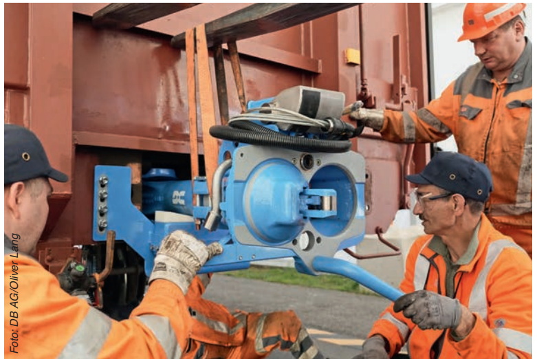
Auf die Menschen kommt es an: Mitarbeitende von DB Cargo beim Einbau einer Digitalen Automatischen Kupplung
