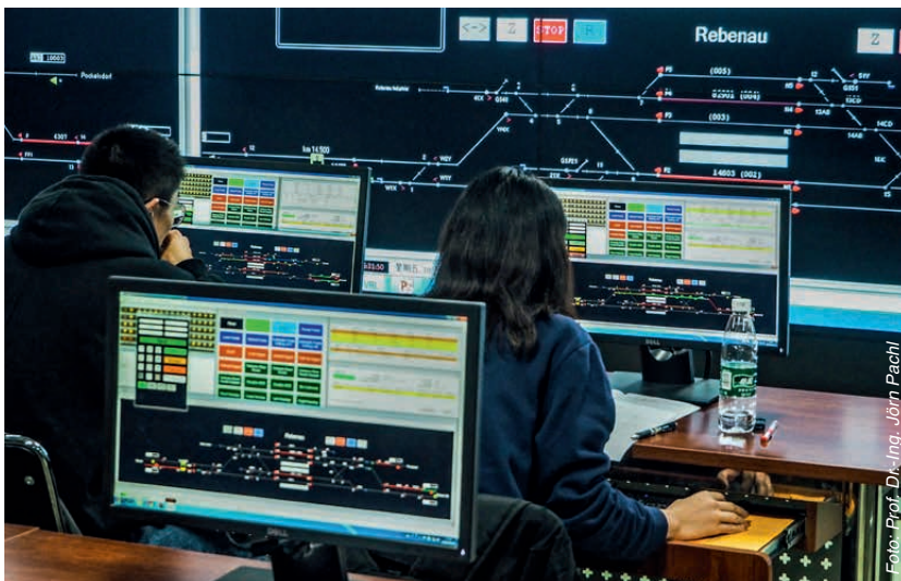
Abbildung 3: Simulation eines Bedienbezirks aus dem Braunschweiger Betriebslabor im Übungsbetrieb an der Beijing Jiaotong University
