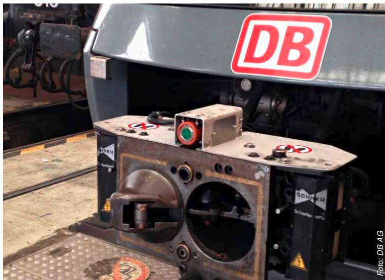
GigaPlug Datenkoppler positioniert auf einer Mittelpufferkuppelung Typ 10
