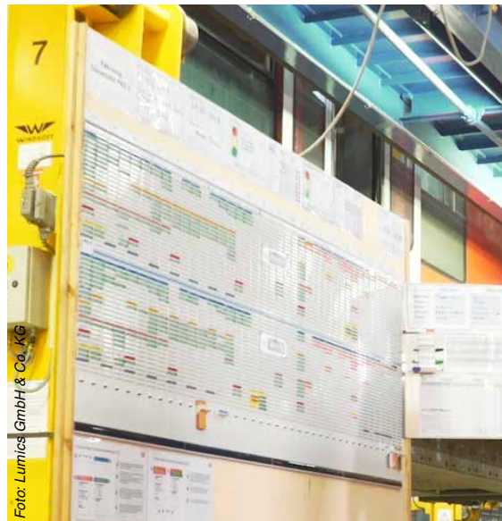
Abbildung 2: Steuerungstafel für die Fahrzeuginstandhaltung
