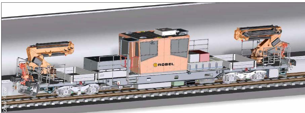
Robel Rorunner Elektro-Gleiskraftwagen für emissionsreduzierte Instandhaltung im Münchner U-Bahn-Netz
